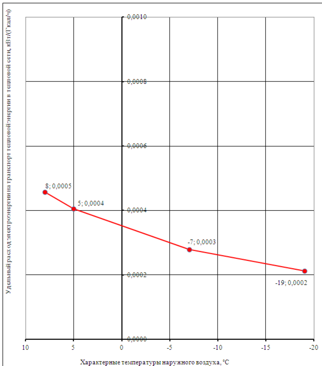
Рисунок 1.38 – График изменения нормируемого удельного расхода электроэнергии на транспорт и распределение тепловой энергии системы теплоснабжения от РТС Восточная при характерных значениях температуры наружного воздуха
